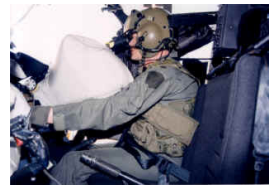
Figura 1.21: Probando un sistema de airbag en un helicóptero OH-58D (fuente Wikipedia).
